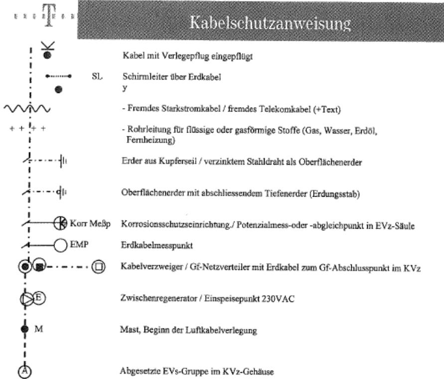
Lediglich die in den Plänen vermerkten Maße (nicht die zeichnerische Darstellung!) geben einen Anhalt für die Lage der dargestellten Telekommunikationsanlagen. Einmessungen an Kabelkanälen beziehen sich auf die Mitte der Abdeckung (Deckel). Alle Maße sind in Meter vermerkt.
