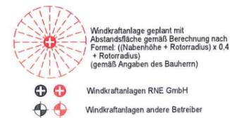
Windkraftanlage WEA 22 geplant:
