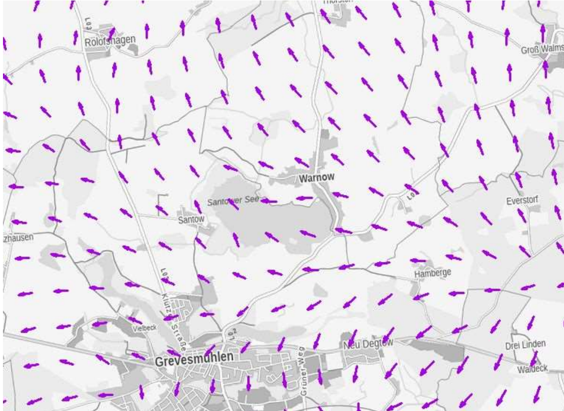
Abbildung 7: Strömungsrichtung im obersten Grundwasserleiter im Untersuchungsraum (Quelle: Umweltministerium Umwelt Mecklenburg – Vorpommern, Seenreferat)
